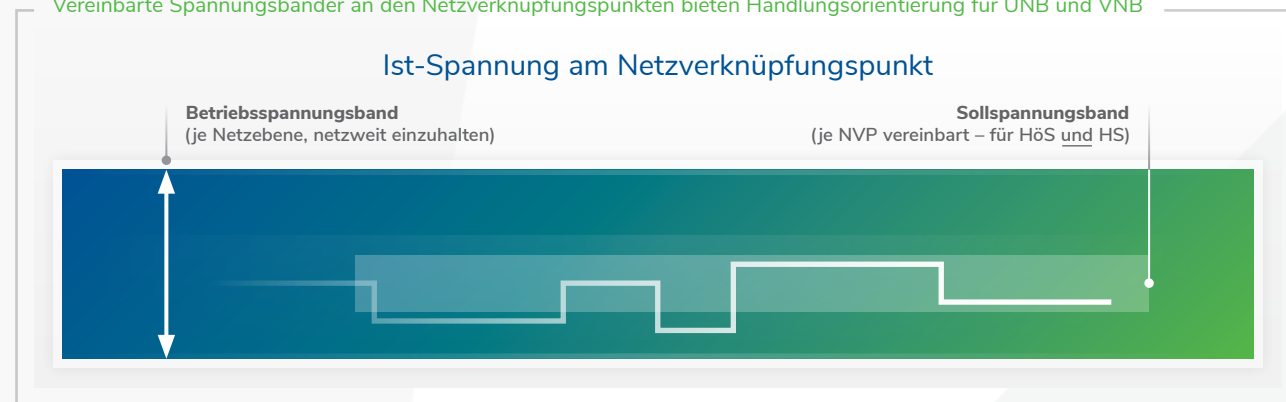
Vereinbarte Spannungsbänder an den Netzverknüpfungspunkten bieten Handlungsorientierung für ÜNB und VNB
